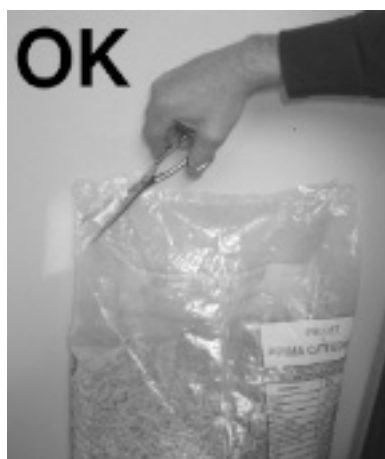
Fig. 21 - Właściwe otwarcie worka z peletami
