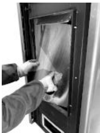
Rys. 87 - Demontaż tylnego panelu paleniska
