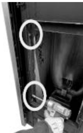
Rys. 84 - Odkręcić śruby sześciokątne
