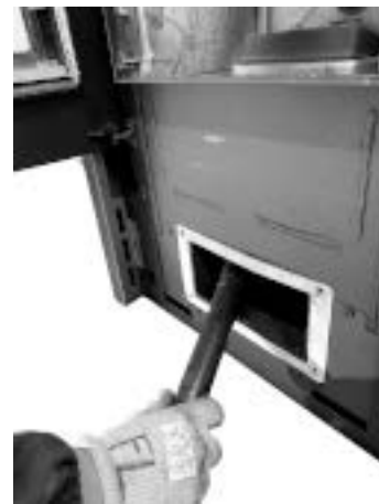
. 81 - Czyszczenie za pomocą wyciora do rur . 82 - Odkurzanie popiołu
